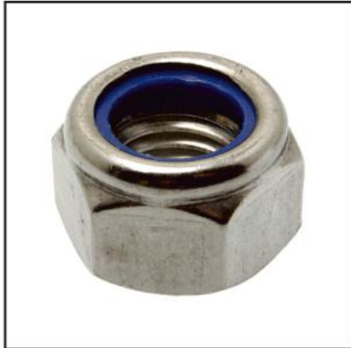
DIN 985 Tuerca Autoblocante Con Insercion No-Metalica
